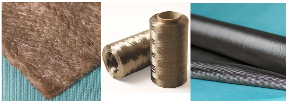
Fig. 10: a) lana de basalto, b) hilo de basalto y c) tejido de basalto o geotextil.
