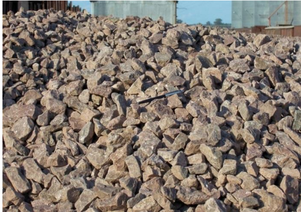
Fig. 2: acopios de basalto utilizados como balasto.
